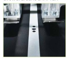
Nachdem die Faltung abgeschlossen ist, werden die Artikel auf einem Stapler gestapelt. Standardmäßig wird die **t.Towel** mit 3 Staplern geliefert. Als Option ist ein 4. Stapler möglich sowie auch ein Stapler mit unterschiedlicher Breite.
