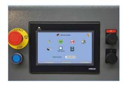
Die **t.Towel** hat eine PLC-basierte Steuerung. Die Bedienung der Maschine erfolgt mittels eines gebrauchsfreundlichen 7" Farb-Touchscreen. Die Steuerung benötigt eine hohe Rechenleistung und deshalb hat sich TEXFINITY für OMRON entschieden.
