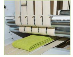
Die **t.Towel** ist mit zwei Querfalten-Sektionen ausgerüstet. Jede Querfaltung erfolgt durch Reversierriemen in Kombination mit einem Luftstrahl. Das Ergebnis ist eine sehr präzise und feste Faltung. Durch das Programmieren der Faltpositionen können mehrere Querfaltmuster realisiert werden. Auch ein Bypass (keine Querfaltung erforderlich) ist möglich.
