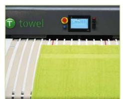
Die **t.Towel** ist mit einer speziellen Funktion ausgestattet, um Artikel zu falten, die vor dem Falten extra korrigiert werden müssen, wie beispielsweise Spannbettlaken. Nachdem das Laken auf den Eingabetisch gelegt und die Taste gedrückt wurde, läuft das Artikel in die Maschine und stoppt automatisch für Korrekturen des Endstücks. Dann drückt der Bediener die Taste ein zweites Mal, damit der Faltvorgang gestartet werden kann.
