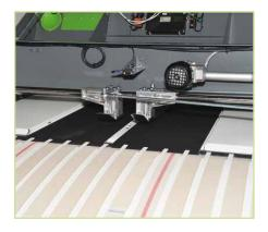
Wenn zwei Faltmaschinen nebeneinander verwendet werden, kann jede über ihr eigenes Abförderband verfügen. Alternativ können beide Maschinen in einer Master-/S-lave-Konfiguration verknüpft werden.
